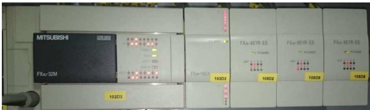
Rys. 2.6 Sterownik Mitsubishi typu FX3U o zasilaniu AC 100-240 V; zintegrowane wejście 16 DC 24 V i zintegrowane wyjście tranzystorowe 16 DC oraz moduły zewnętrzne
