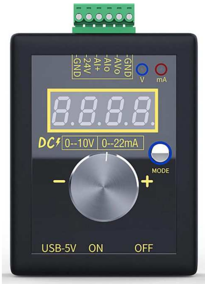
Rys. 2.22 Generator sygnału standardowego do diagnostyki obwodów sterownika
