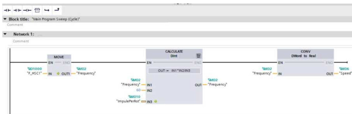
Rys. 6.51 Program LAD – wyliczenie prędkości z licznika impulsów HSC
