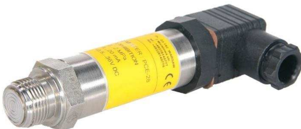
Rys. 2.15 Przetwornik ciśnienia PC-28 Smart z protokołem HART firmy SIMEX; zakres pomiarowy -100 do +150 kPa, sygnał wyjściowy: 4...20 mA (dwuprzewodowy) lub 0...10 V (trójprzewodowy)
