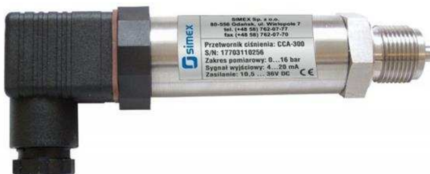
Rys. 2.13 Przetwornik ciśnienia CCA-300 firmy SIMEX; zakres pomiarowy od -1...0 bar do 0...16 bar, sygnał wyjściowy: 4...20 mA, czujnik piezorezystancyjny krzemowy, dokładność 0,25%, sygnał wyjściowy 4...20 mA (2-przewodowe) lub 0...10V (3-przewodowe)
