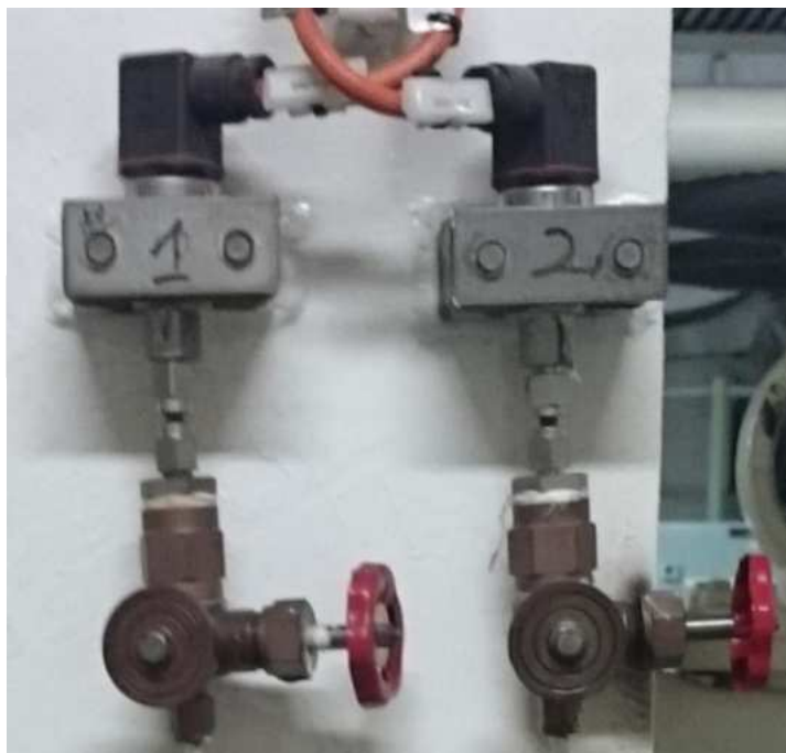
Rys. 2.18 Pomiar ciśnienia – układ rzeczywisty
