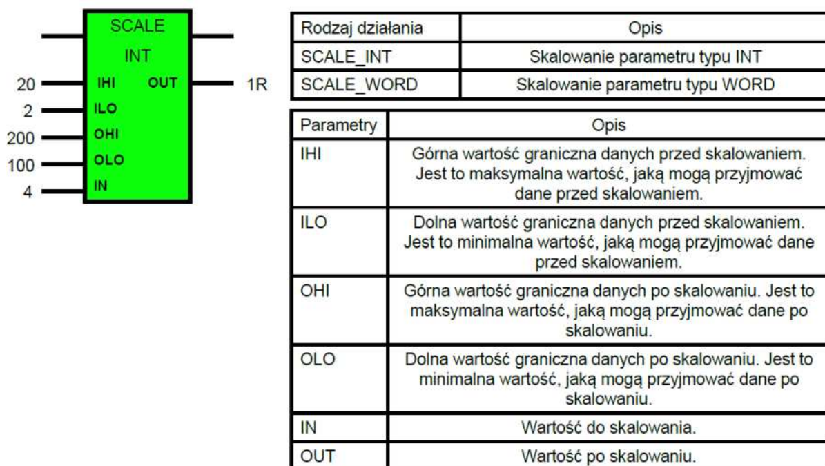
Rys. 5.32 Funkcja skalowanie wartości SCALE dla sterownika GE-Fanuc 90 - 30
