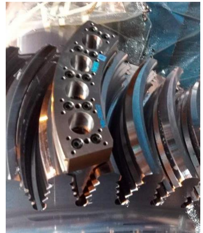
Rys. 2. Widok połączenia zamkowego typu „jodła” w tarczy turbiny gazowej
