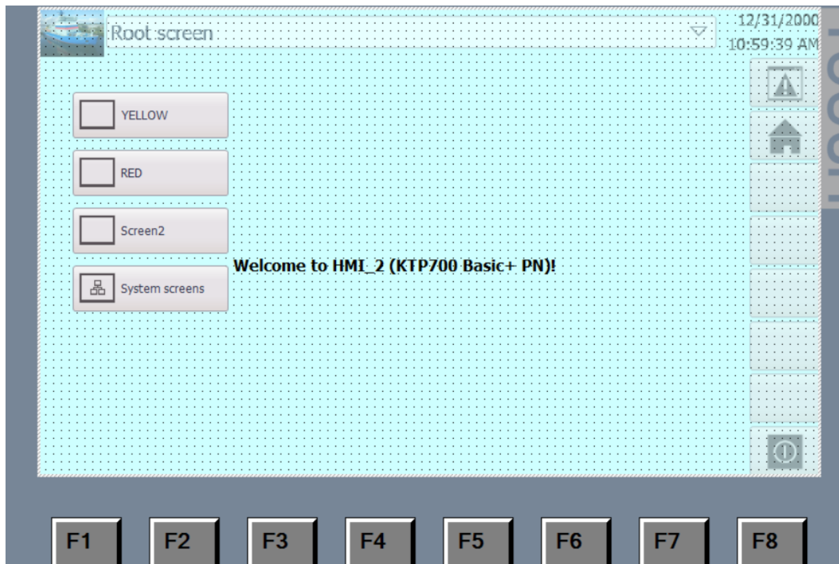
Rys. 1.9 Widok zaprojektowanego ekranu głównego panelu HMI
