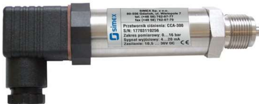
Rys. 1.1 Przetwornik ciśnienia CCA-300 firmy SIMEX; zakres pomiarowy od 0 do 16 bar, sygnał wyjściowy: 4...20 mA, czujnik piezorezystancyjny krzemowy, dokładność 0,25%, sygnał wyjściowy 4...20 mA (2-przewodowe) lub 0...10V (3-przewodowe)
