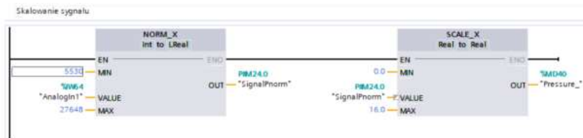
Rys. 3.10 Skalowanie sygnału według parametrów przetwornika, 0 – 16bar, 4 – 20mA
