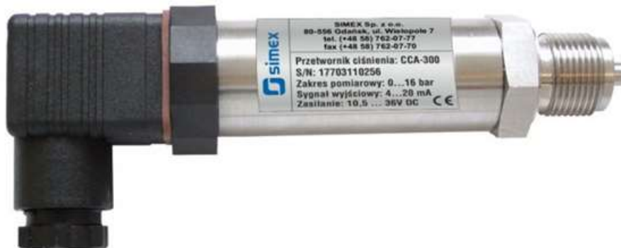
Rys. 3.9 Przetwornik ciśnienia CCA-300 firmy SIMEX; zakres pomiarowy od 0 do 16 bar, sygnał wyjściowy 4..20 mA,
