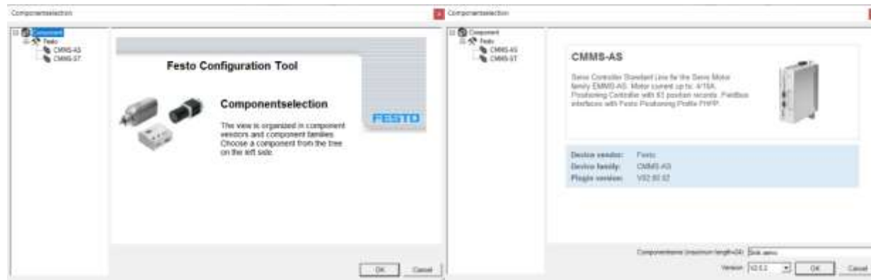
Rys. 3.2 Wybór sterownika silnika servo w programie FCT
