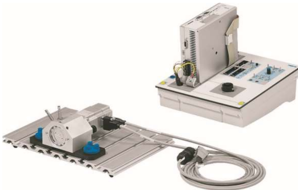
Rys. 0.1 Elementy stanowiska dydaktycznego – sterownik z silnikiem krokowym
