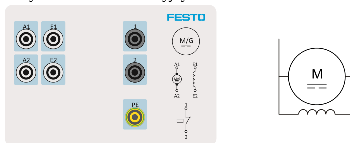
Rys. 3.3 Uzwojenia silnika prądu stałego bocznikowego – tabliczka podłączeniowa
