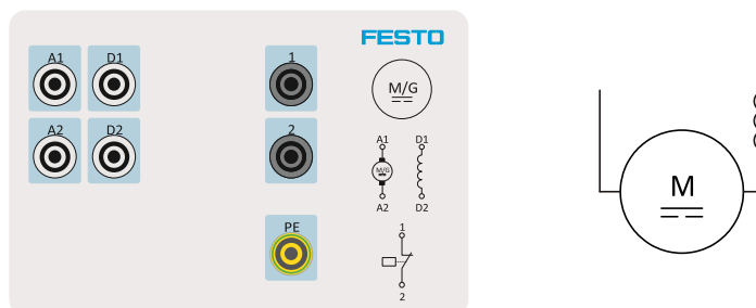
Rys. 3.5 Uzwojenia silnika prądu stałego szeregowego – tabliczka podłączeniowa
