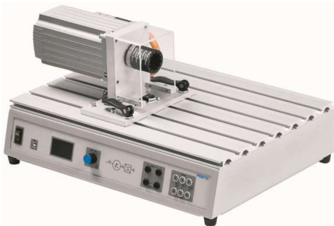
Rys. 1.1 Elementy stanowiska dydaktycznego – układ napędowy
