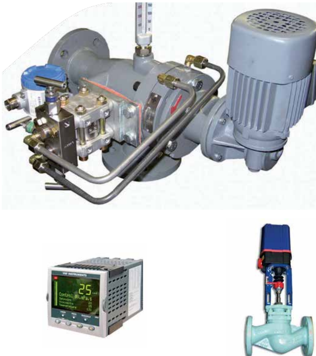
Rys. 12. Elementy automatyki regulacji lepkości paliwa. a) unowocześniona wersja wiskozymetru z rurką kapilarną i dołączonym przetwornikiem różnicy ciśnień na sygnał elektryczny, b) regulator elektroniczny, c) element wykonawczy – zawór parowy z elementem nastawczym
