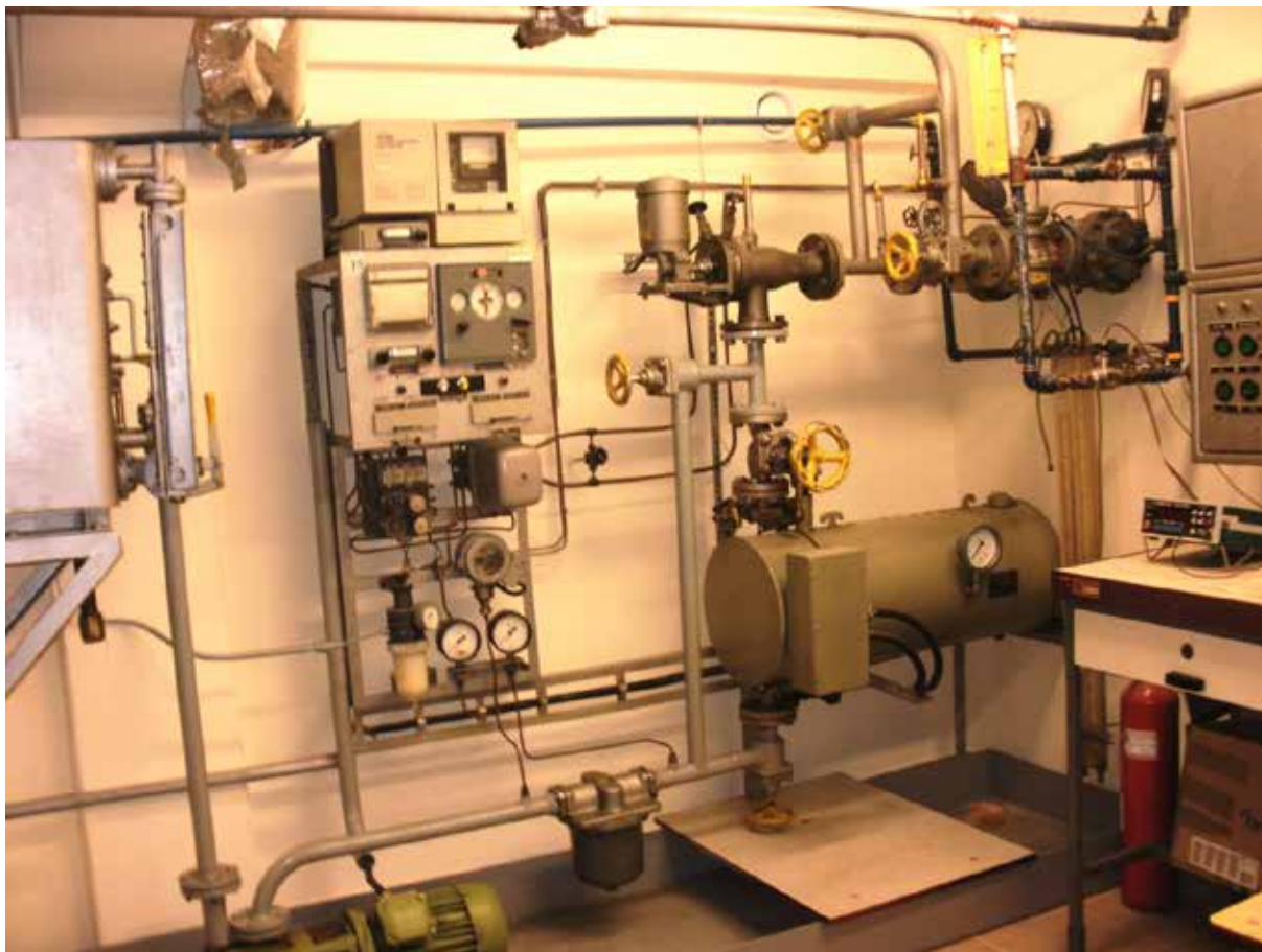
Rys. 20 Stanowisko laboratoryjne do pomiaru lepkości paliwa.
