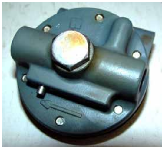
Rys. 11 Regulator małych przepływów, a-widok zewnętrzny regulatora z widocznym zaworem iglicowym, b-zespół regulatora z rotametrem.
