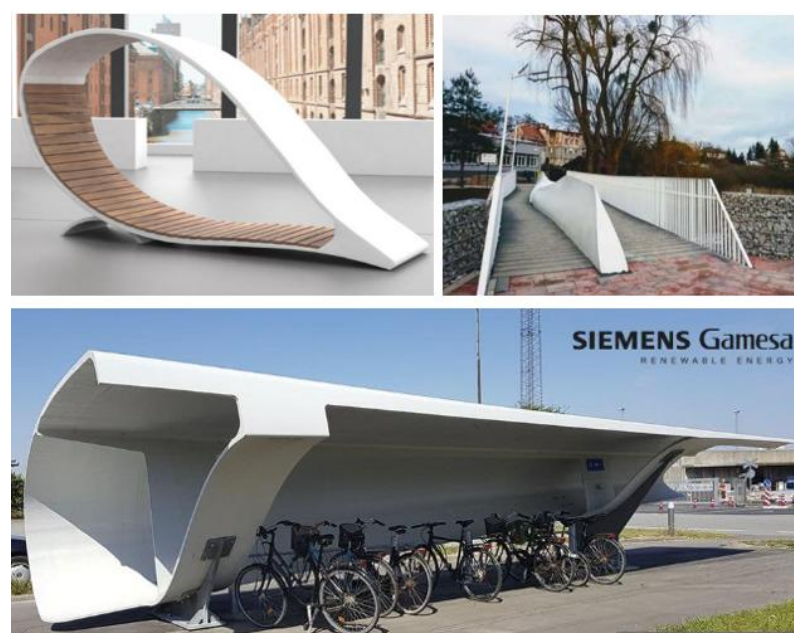
Rys. 2. Przykłady recyklingu łopat morskich turbin wiatrowych poprzez zmianę przeznaczenia
