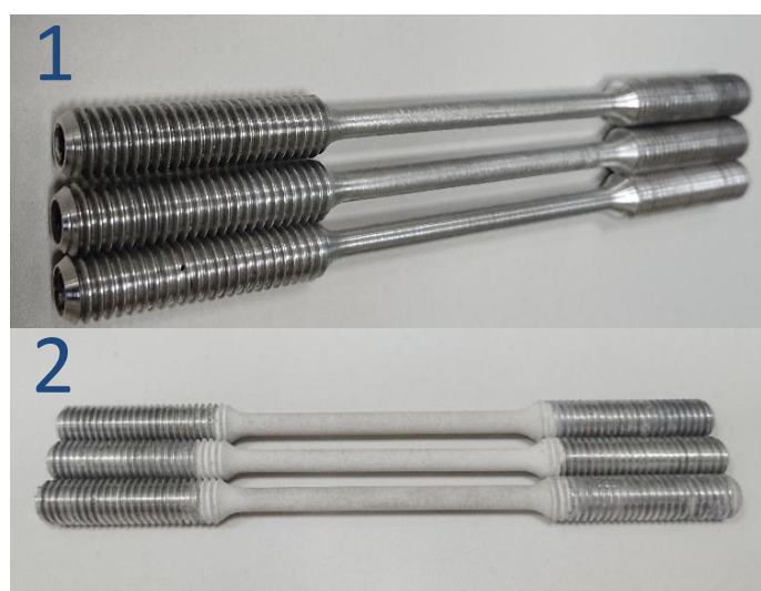
Rys. 1. Zdjęcie przedstawiające próbki (próbki w stanie dostawy – 1, pokryte powłoką MAO - 2) wykorzystane w badaniach korozji naprężeniowej
