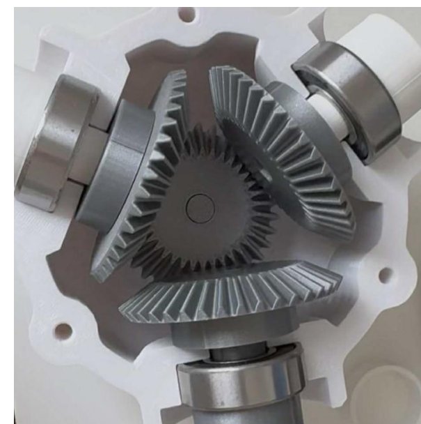
Rys. 2. Montaż przekładni stożkowej w przedniej części gondoli
