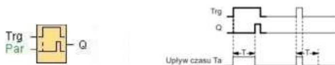
Rys. 4.12 Timer On-Delay, symbol i wykres czasowy
