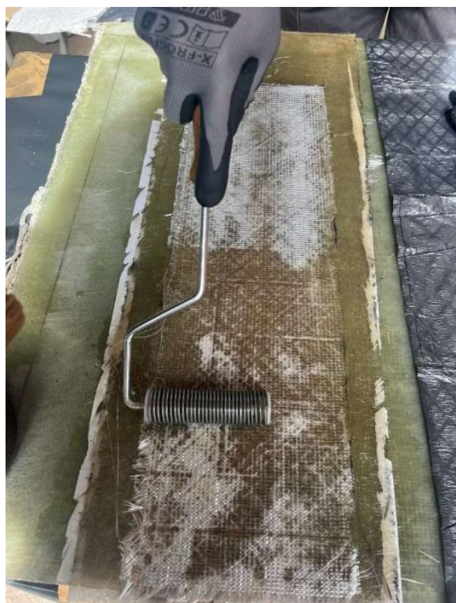
Rys. 1. Zdjęcie procesu laminowania ręcznego
