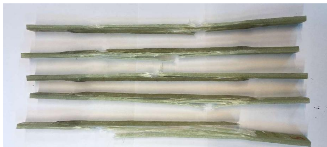
Rys. 3. Zdjęcie próbek z zakładką 20 mm po próbie rozciągania
