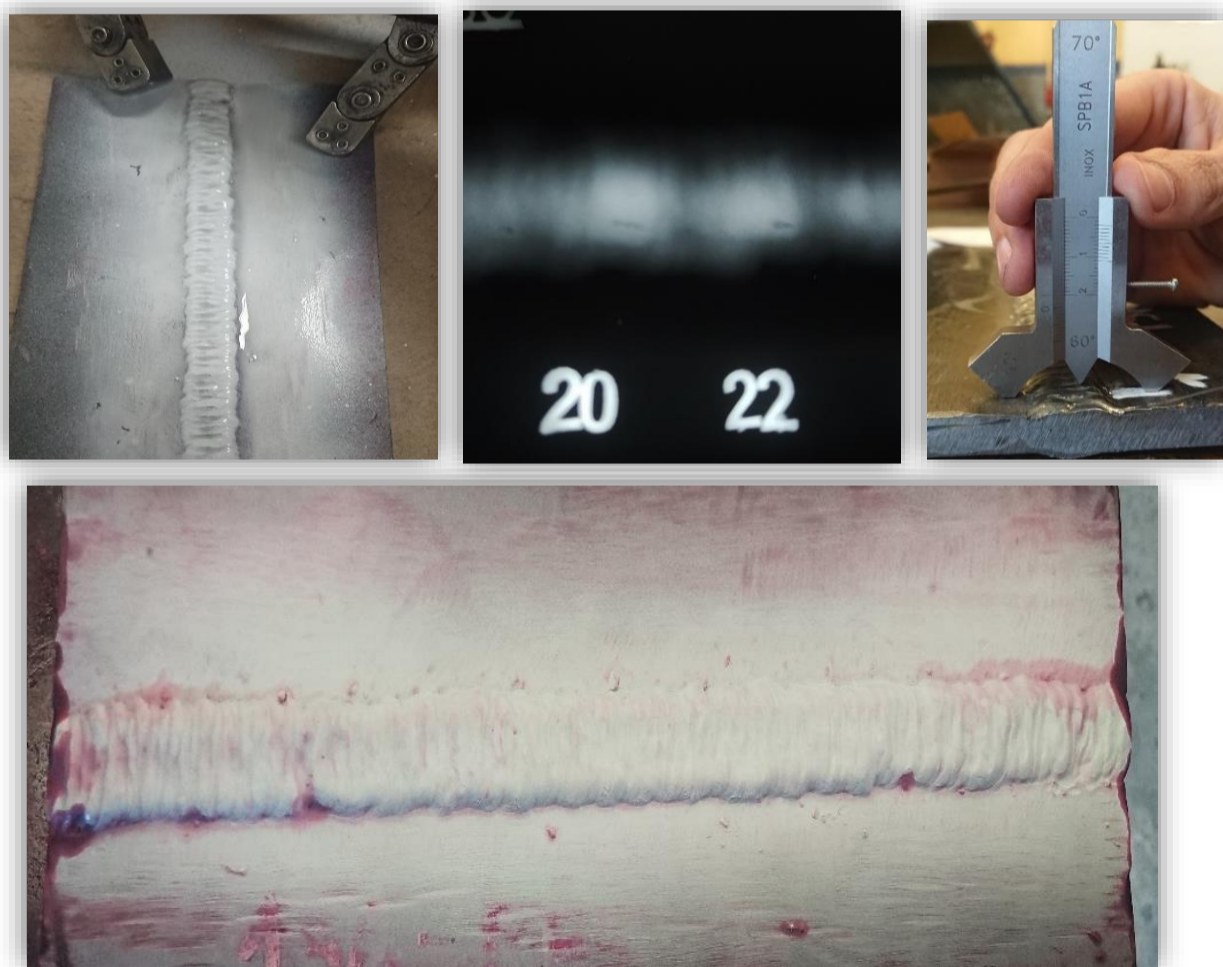
Rys. 1. Fotografie wykonane podczas wykonywania poszczególnych badań – magnetyczno-proszkowe, radiograficzne, wizualne, penetracyjne.
