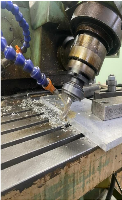
Rys. 2. Widok procesu przygotowywania krawędzi blach oraz procesu spawania
