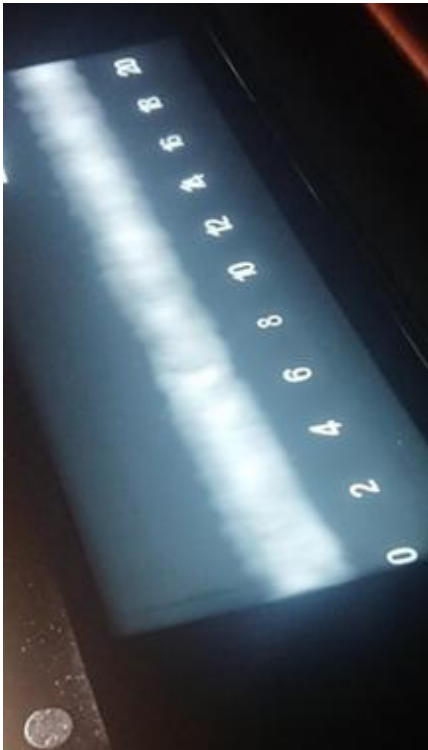
Rys. 3. Widok otrzymanej spoiny oraz radiogramu z badania złącza spawanego
