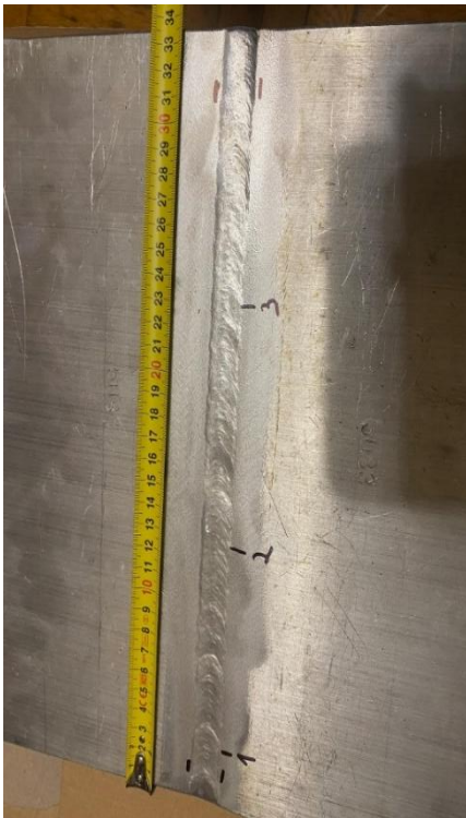
Rys. 3. Widok otrzymanej spoiny oraz radiogramu z badania złącza spawanego
