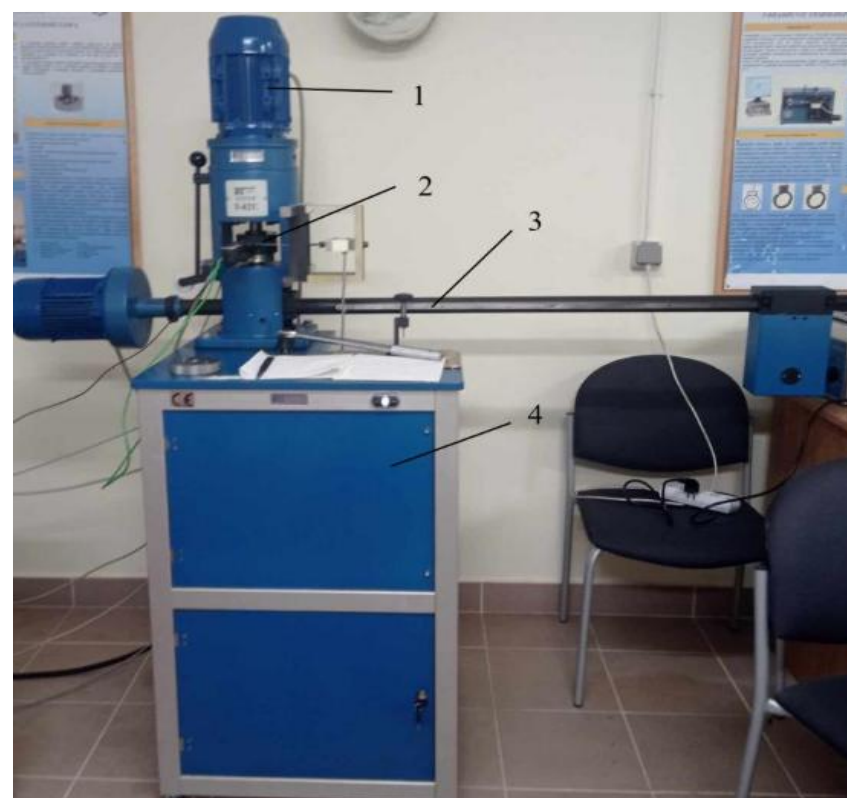
Rys. 3. Zdjęcie aparatu czterokulowego: 1 – zespół napędowy, 2 – zespół mocujący kulki, 3 – zespół obciążający węzeł tarcia, 4 – podstawa
