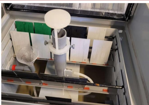
Rys. 2. Widok próbek znajdujących się w komorze mgły solnej SaltCab firmy ANTICORR
