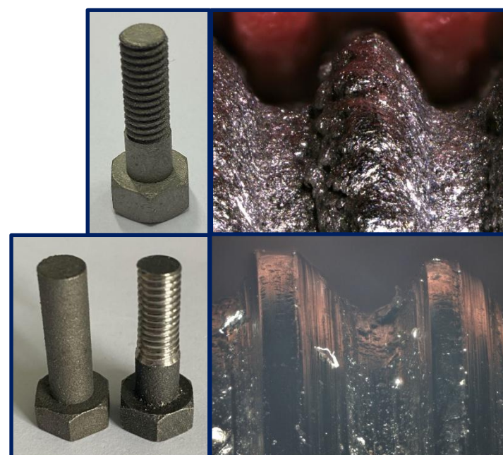
Rys. 3. Zdjęcie struktury zewnętrznej wydrukowanego gwintu ze stali narzędziowej 1.2709 śruby M6 w powiększeniu x200 oraz po wykonaniu gwintu narzynką również w tym samym powiększeniu
