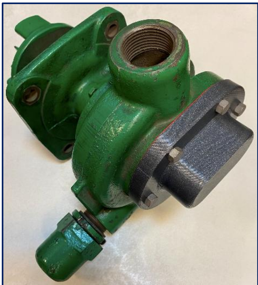
Rys. 1. Zdjęcie wydrukowanych modeli pokrywy, uszczelki i śrub na pompie zębatej ORSTA Afü 1.0/16
