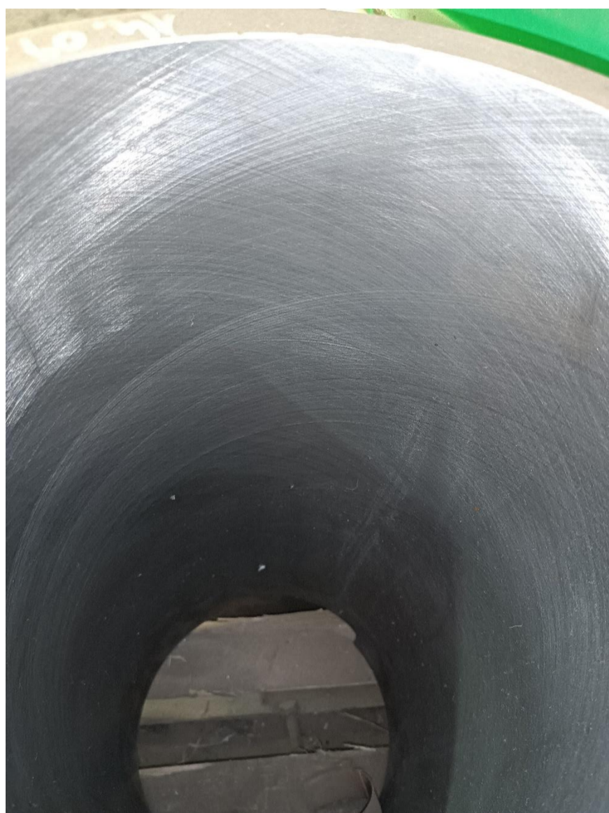
Rys. 1. Zdjęcie powierzchni gładzi cylindrowej po operacji szlifowania krzyżowego na honownicy automatycznej. Dobrze widoczne eliptyczne ślady obróbki.
