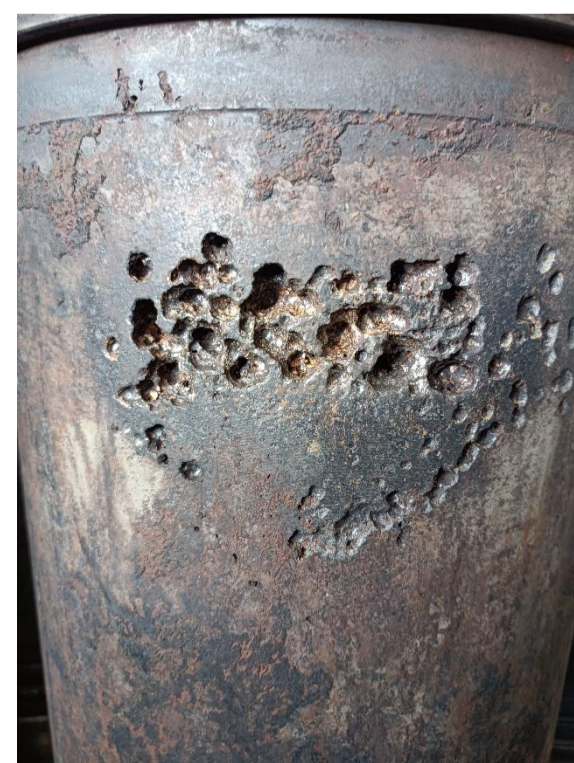
Rys. 3. Zdjęcie uszkodzenia kawitacyjnego zewnętrznej powierzchni walcowej, omywanej cieczą chłodzącą. Głębokość wżerów dyskwalifikująca tuleję z procesu regeneracji podczas selekcji.
