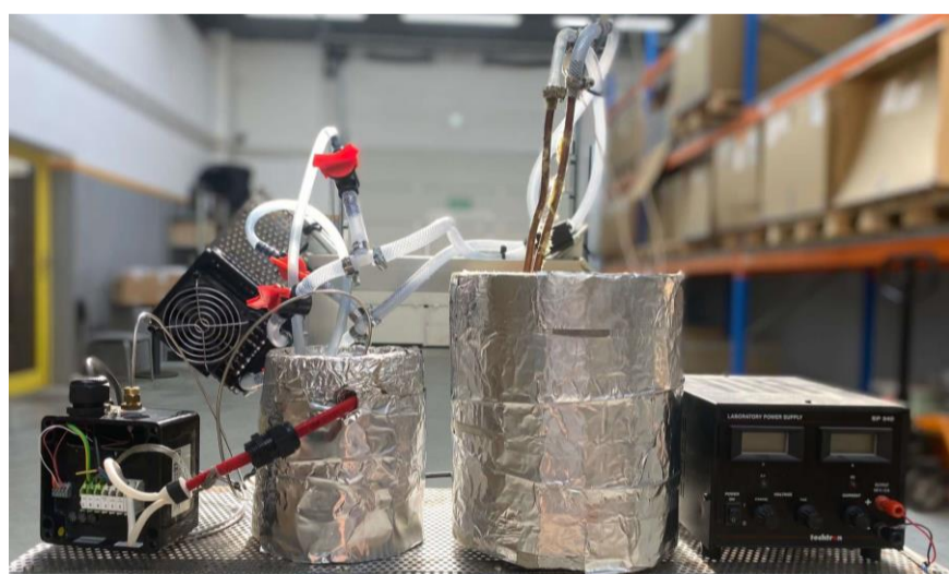
Rys. 1 Zdjęcie przedstawiające stanowisko badawcze nad zdolnością parafiny R-58 do magazynowania ciepła z wykorzystaniem przemiany fazowej
