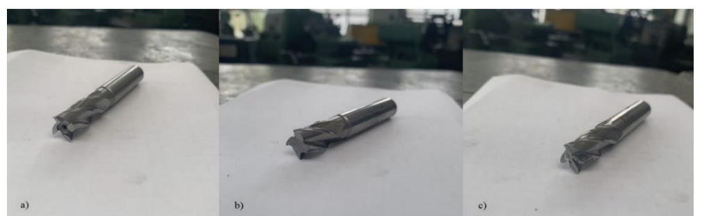
Rys. 4. Frez trzpieniowy do obróbki walcowo – czołowej: a) frez nowy, b) frez stępiony, c) frez z wytłamanym ostrzem
