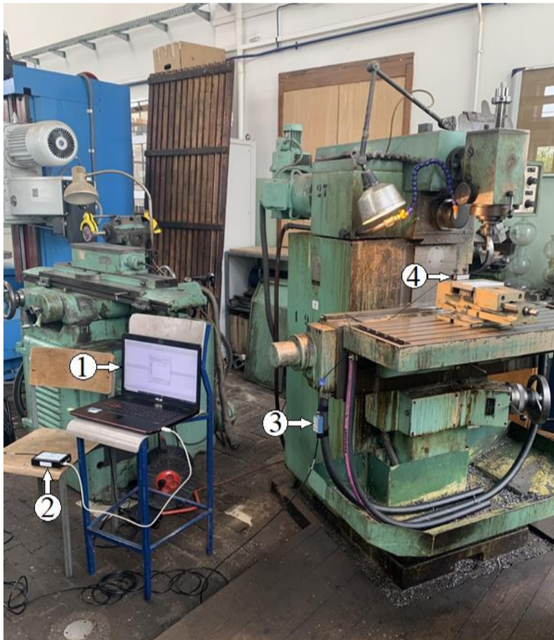
Rys. 1. Stanowisko pomiarowe emisji akustycznej: 1 – komputer wraz z oprogramowaniem, 2 – analizator sygnału, 3 – przedwzmacniacz sygnału, 4 – czujnik wraz z chwytem magnetycznym
