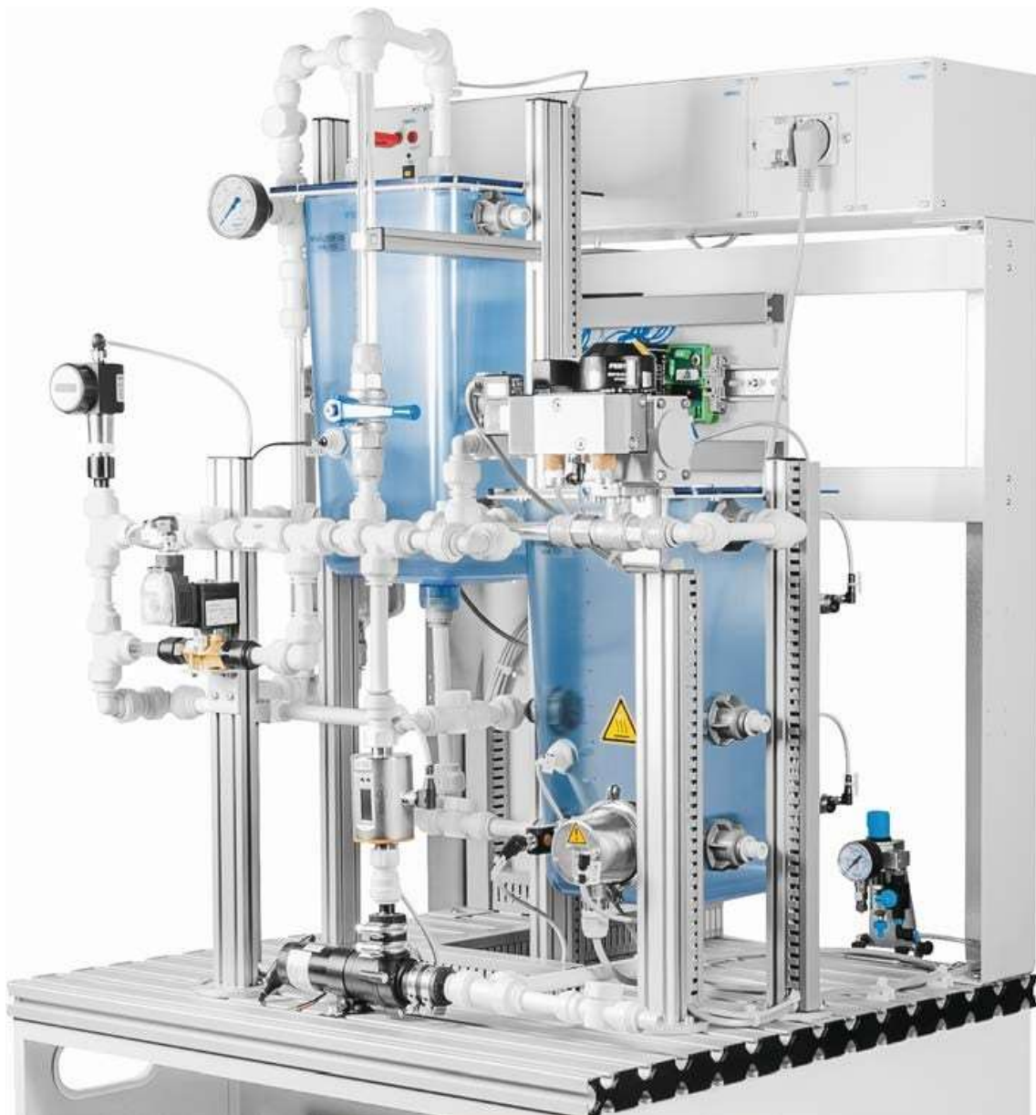
Rys. 2.1 Stanowisko modułowe układu zbiorników
