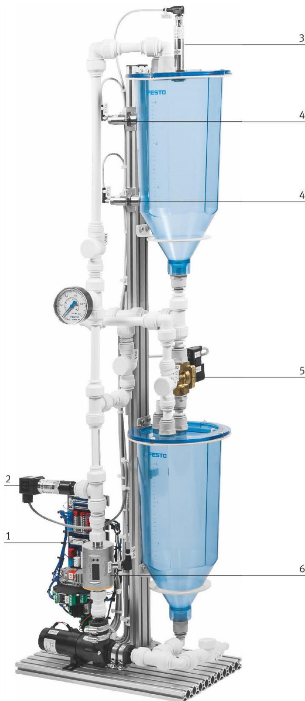
Rys. 2.2 Stanowisko z układem pompowym do badania charakterystyk członu całkującego
