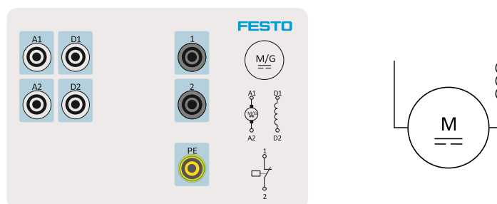
Rys. 3.5 Uzwojenia silnika prądu stałego szeregowego – tabliczka podłączeniowa
