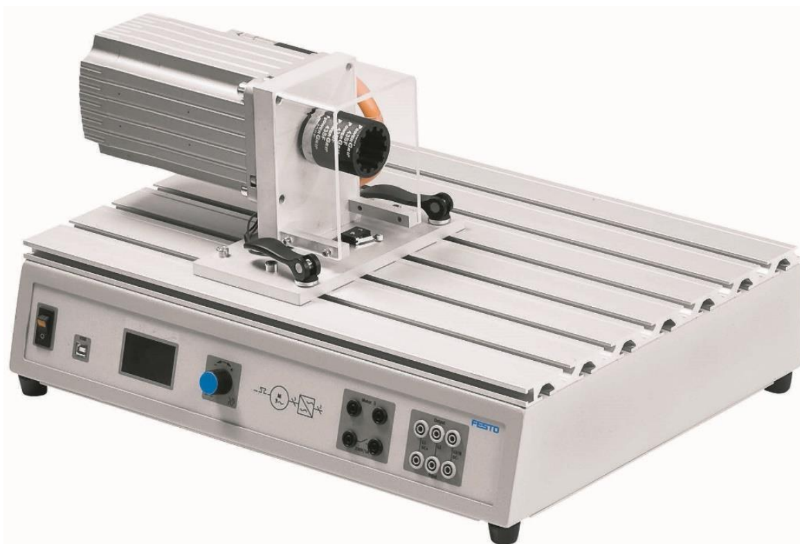
Rys. 1.1 Elementy stanowiska dydaktycznego – układ napędowy
