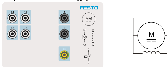
Rys. 3.3 Uzwojenia silnika prądu stałego bocznikowego – tabliczka podłączeniowa
