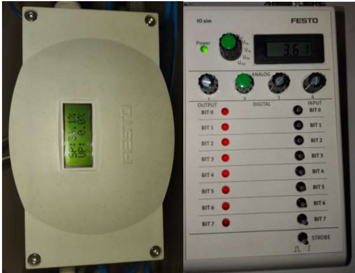
Rys. 2.4 Pozycjoner aktuatora pneumatycznego ze wskazaniem SP – set point i VP – valve position; symulator sygnałów binarnych i analogowych
