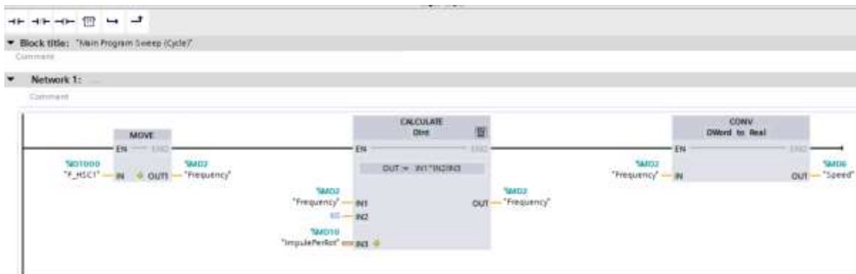
Rys. 15 Program LAD – wyliczenie prędkości z licznika HSC
