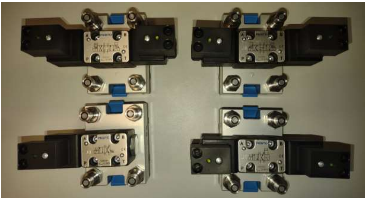
Rys. 3.19 Zawory hydrauliczne sterowane elektrycznie – wyposażenie laboratorium automatyki
