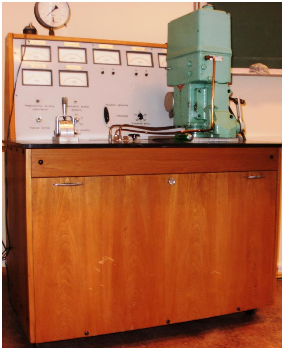
Rys. 14. Stanowisko laboratoryjne do symulacji układu regulacji prędkości obrotowej z regulatorem woodward'a PGA.
