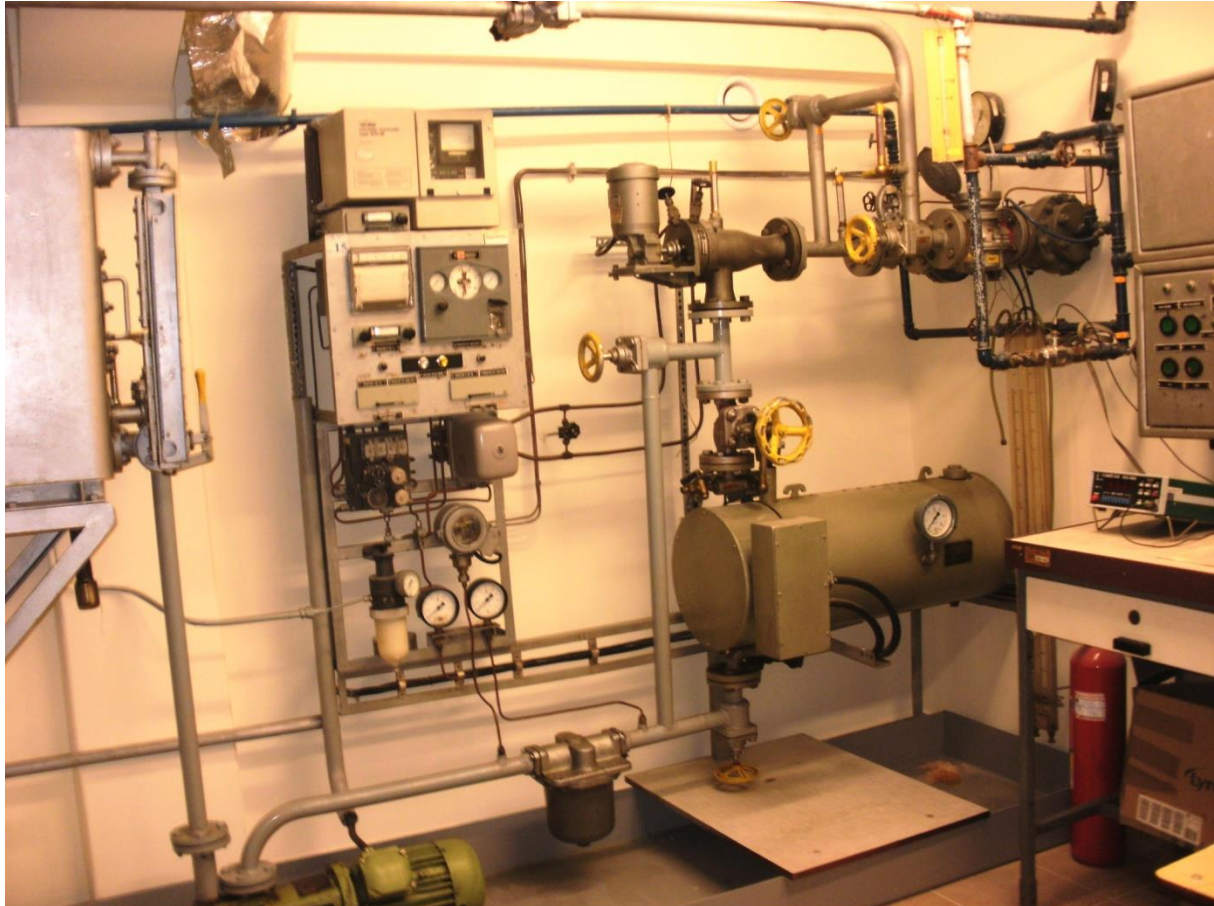
Rys. 20 Stanowisko laboratoryjne do pomiaru lepkości paliwa.
