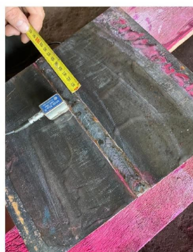
Rys. 4. Pomiary położenia wykrytej niezgodności w badaniach UT: a) pomiar położenia w osi x, b) pomiar echa, wymiarów oraz położenia niezgodności w pozostałych osiach
