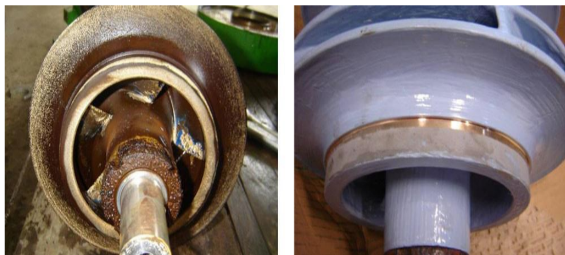
Rys. 2. Przykład- regenerowany wirnik pompy; z lewej - wirnik przed regeneracją, z prawej - wirnik pokryty materiałem kompozytowym
