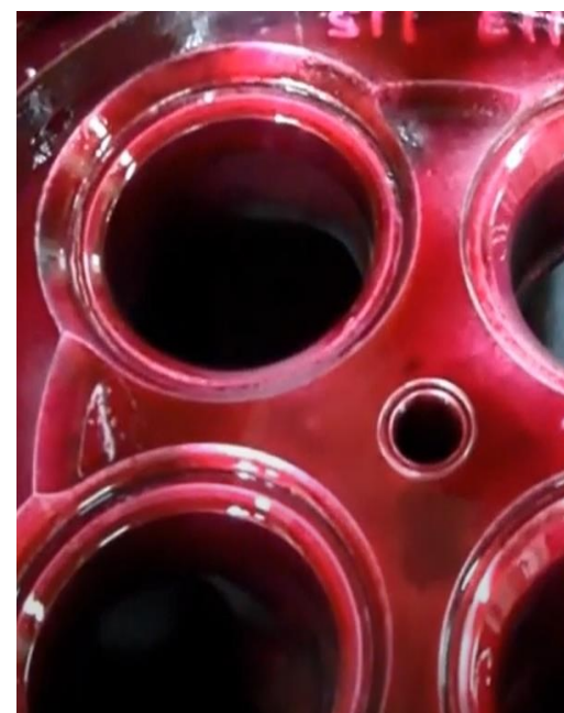
Rys. 5. Głowica pokryta penetrantem podczas badania penetracyjnego
