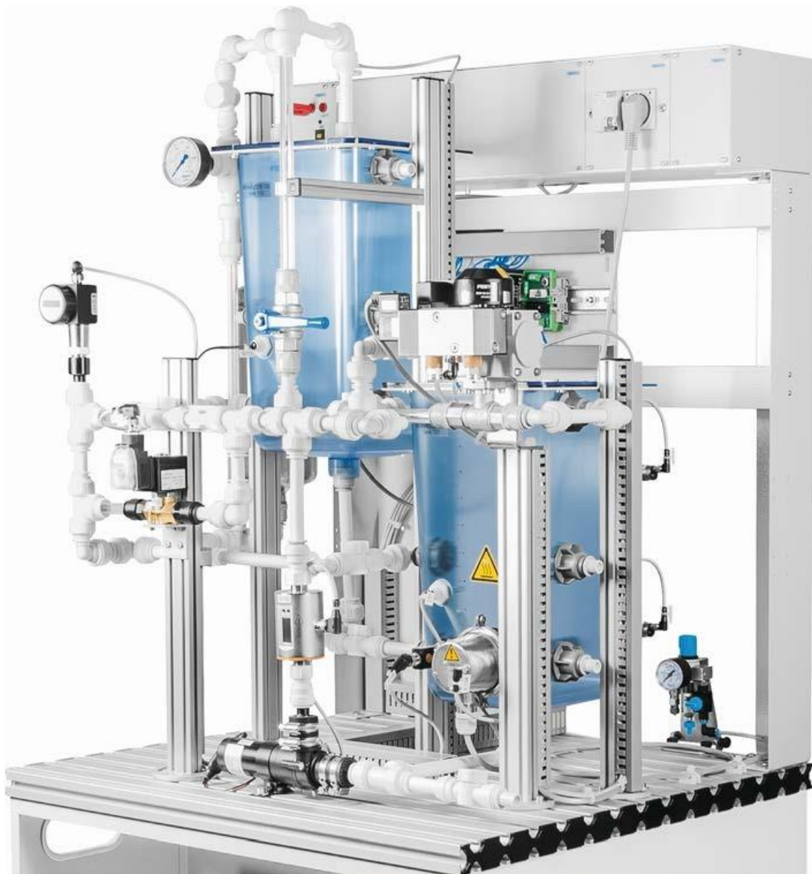
Rys. 2.1 Stanowisko modułowe układu zbiorników
