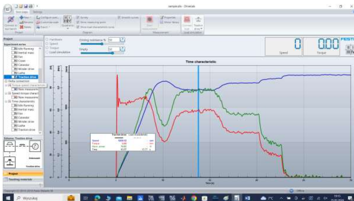
Rys. 4.24 Charakterystyka dynamiczna rozruchu i zatrzymania silnika trójfazowego z obciążeniem trakcyjnym, połączenie Y
