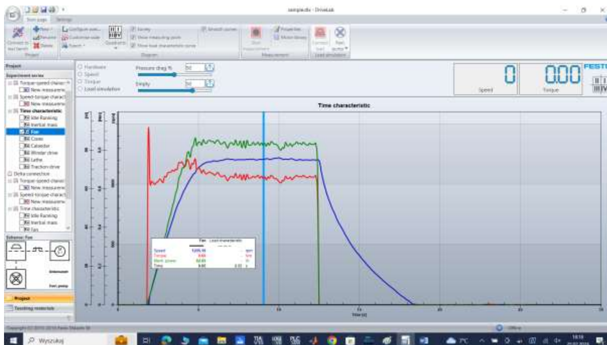
Rys. 4.16 Charakterystyka dynamiczna rozruchu i zatrzymania silnika trójfazowego z obciążeniem wirowym pompa/wentylator, połączenie Y
