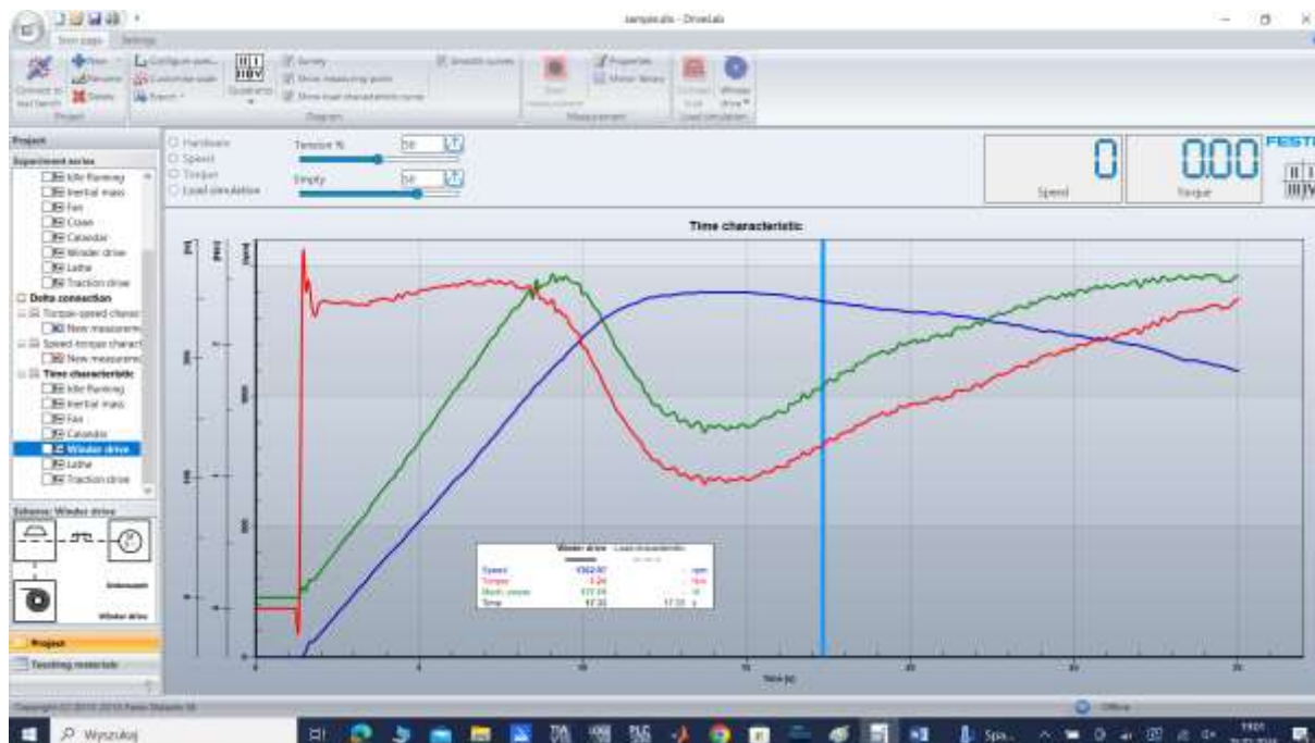
Rys. 4.21 Charakterystyka dynamiczna rozruchu i zatrzymania silnika trójfazowego z obciążeniem wciągarką, połączenie \Delta
