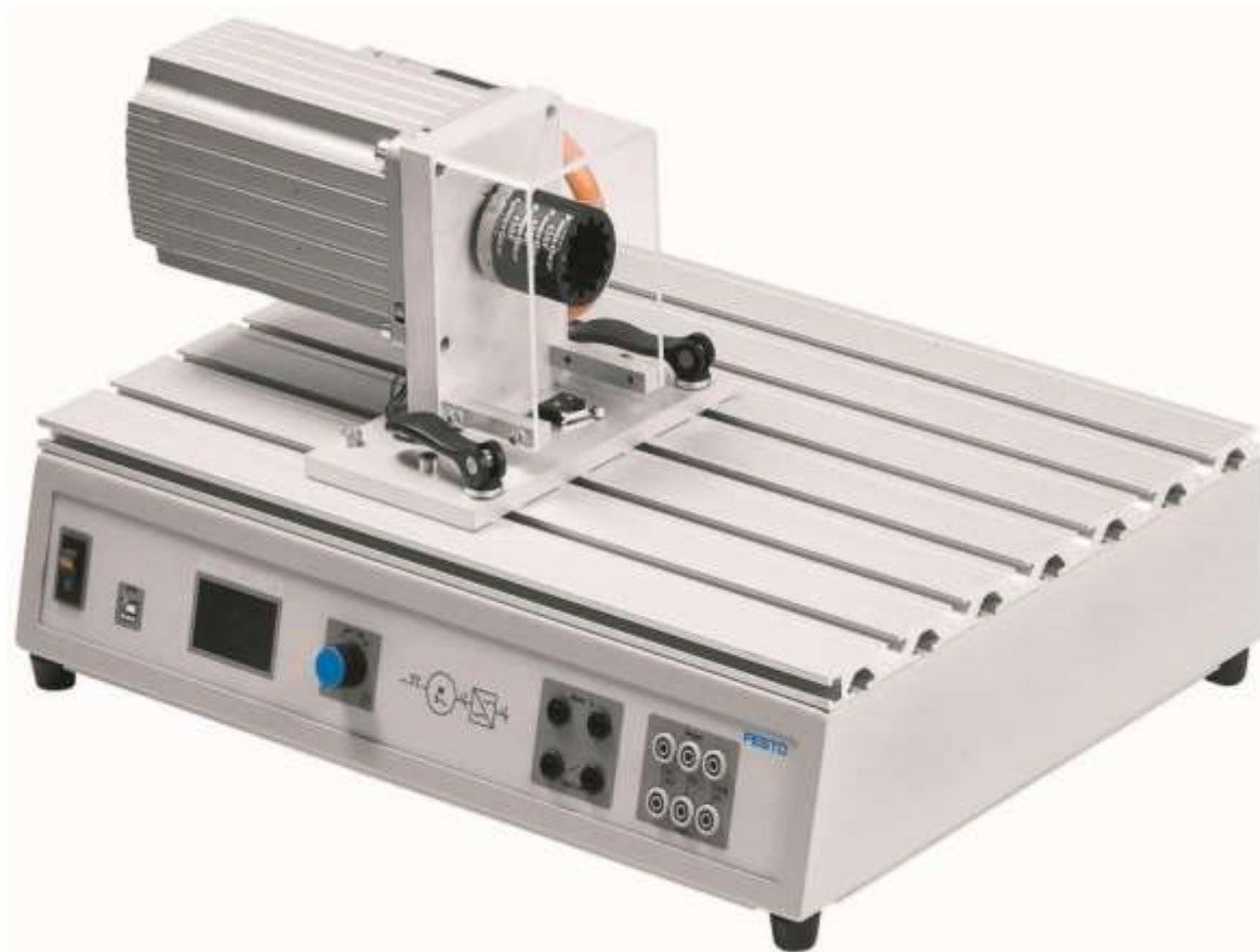
Rys. 1.1 Elementy stanowiska dydaktycznego – układ napędowy
