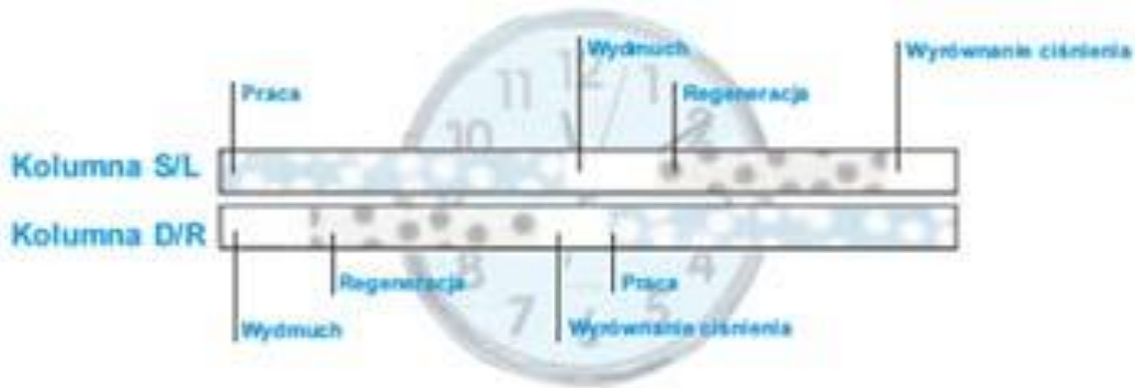
Rys. 2. Wykres czasowy cyklu pracy osuszacza adsorpcyjnego.
